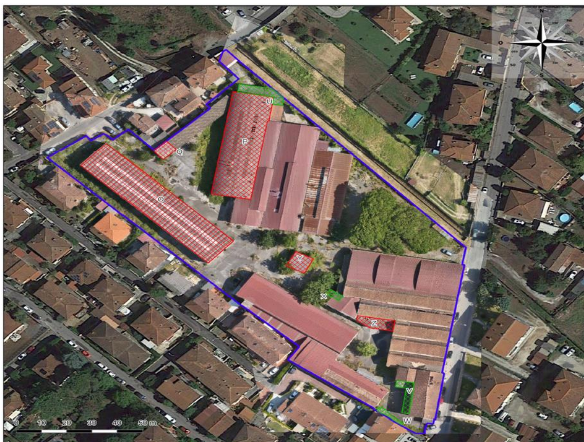
Figura 31. Ubicazione e sigle delle coperture in sospetto MCA
